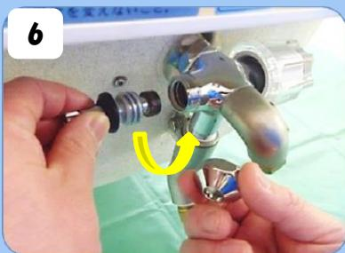
内部の栓棒セットを矢印の方向に回しながら取り外します。
